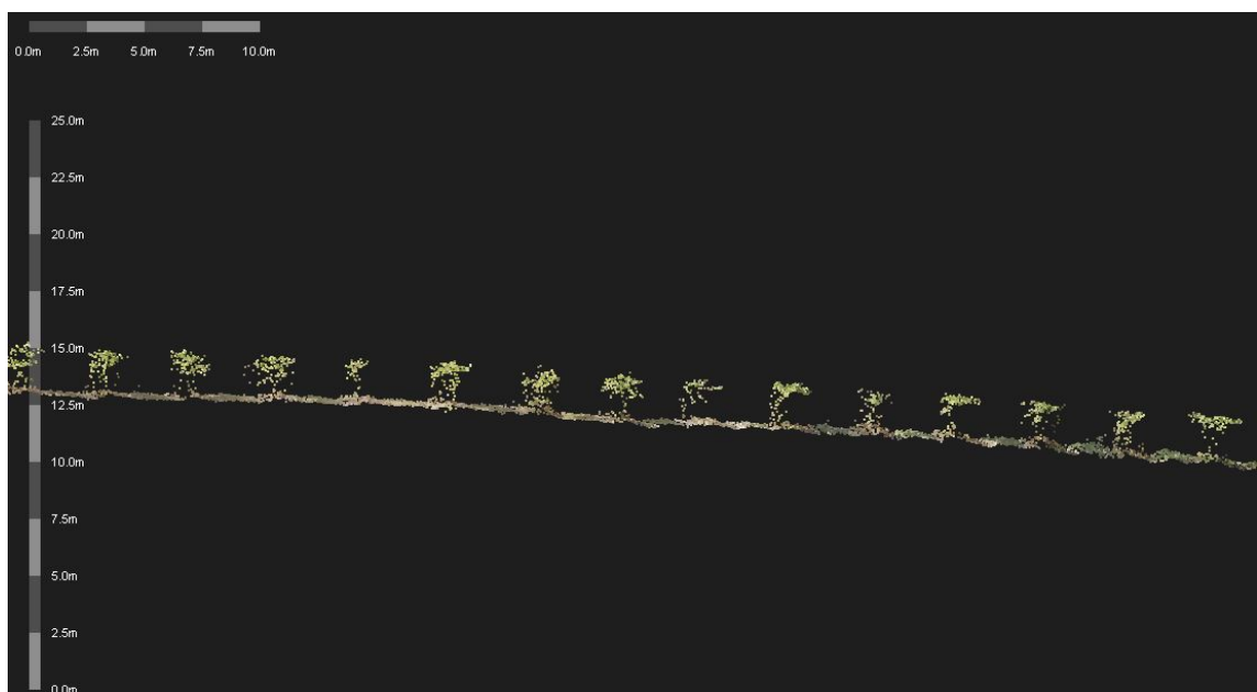
Reconstrucción tridimensional de líneas de plantación en viñedo a partir de nube de puntos (fotogrametría)
